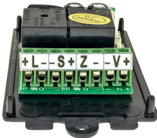
Рисунок 1 – Расположение и назначение клемм для подключения
